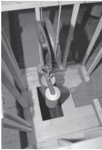
Schwerkraft: 42 Kilogramm wiegen die Eisengewichte, die die Uhr antreiben.
